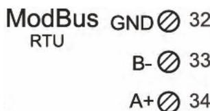
**USCITA SERIALE RS485 Modbus RTU:**
