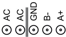
Collegamento T-BUS (necessita dell'accessorio T-BUS opzionale): è possibile apporre l'accessorio T-BUS sulla base del modulo per portare sia l'alimentazione sia la comunicazione seriale (vedi immagine sotto). Il numero di moduli supportati dal bus è in funzione dell'alimentatore utilizzato (verificare gli assorbimenti dei moduli)
