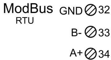
Collegamento RS485 Modbus RTU: morsetti 32, 33 (B-), 34 (A+)
