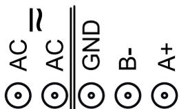
Collegamento T-BUS (necessita dell'accessorio T-BUS opzionale): è possibile apporre l'accessorio t-bus sulla base del modulo per portare sia l'alimentazione sia la comunicazione seriale. Il numero di moduli supportati dal bus è in funzione dell'alimentatore utilizzato (verificare gli assorbimenti dei moduli)
