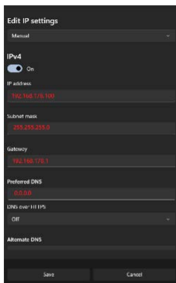
Figura 5: Settaggio IP di rete
