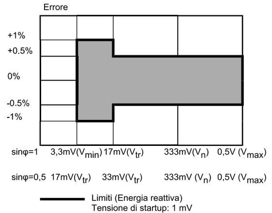
Figura 10: VARh, precisione in funzione del carico (TA con uscita in tensione)
