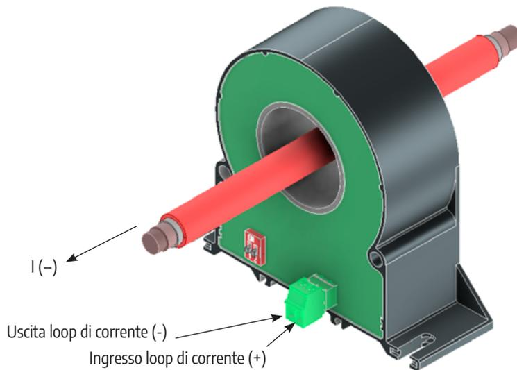
Il conduttore deve essere posizionato il più possibile al centro del prodotto per garantire una corretta misurazione della corrente.
