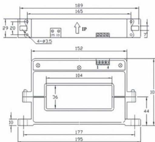
I QI-HSC-104-2000-I permettono la misura di correnti continue o ad ampio range di frequenza. **Dotati di uscita 4÷20 mA**. Utilizzano la tecnica di misura ad effetto di Hall a loop aperto (tramite nucleo apribile), rendendo i sensori facilmente installabili senza scollegare i conduttori. Morsettiere a vite rendono estremamente comoda l'installazione.
